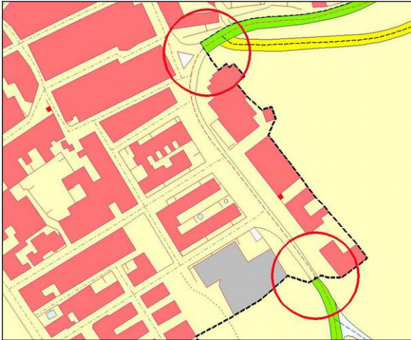
Ejemplo 2: Ejemplo de mala práctica en la captura del relleno. Se debería haber dado continuidad al relleno de la carretera.
